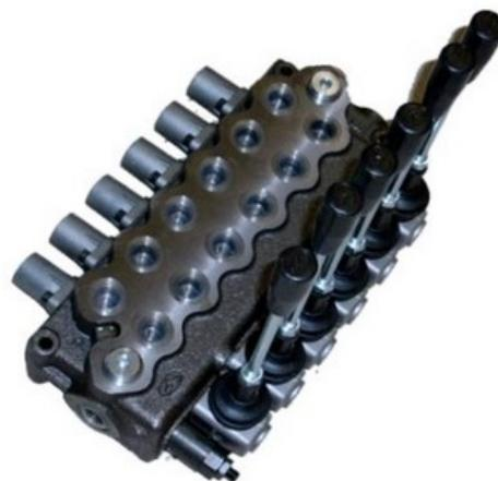
Dieses Ventil findet umfangreiche Anwendung in der Steuerung von Zylindern und anderen Verbrauchern. Hauptanwendungsfall ist der Einsatz zum steuern von bis zu 7 einfach oder doppelwirkenden Zylindern.
