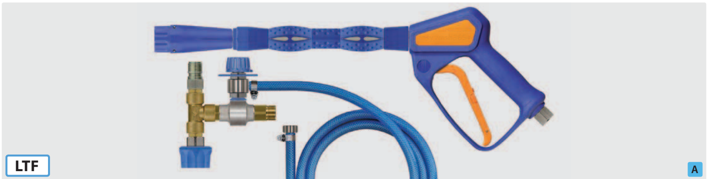
easywash365+ Schaumset: easywash365+ Schaumlanze Standard mit Schaumdüse ST-75, Injektor ST-160 (Kupplung ST-45-250 Messing vernickelt, Stecknippel ST-45-250 Stahl verzinkt und M22 AG) mit Dosierventil ST-161, Saugschlauch 1.000 mm und Saugfilter ST-32. Max. 250 bar / 90 °C
