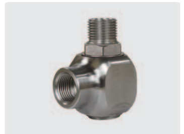
1/2" IG : 1/2" AG. DN 12. Max. 300 bar / 30 U/min / 90 °C
